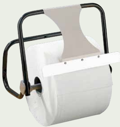
◀ Ref. JP00224 Portarrollos de pared para bobinas industriales en acero lamin. Pintado en pintura epoxi color gris grafito con sierra. Medidas: 405 x 265 x 375 H.
