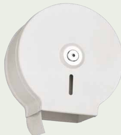
Ref. JP00208 ▶ Portarrollos higienico ind. En chapa electrocincada y pintura epoxi blanca D-45, cierre con llave y visor. Capacidad: rollo 300 mts. Medidas: 265 x 120 x 265 H
